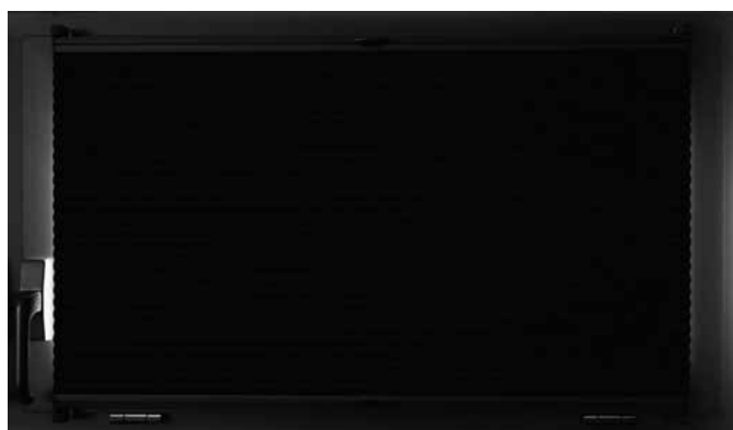
Duette® Wabenplissee -Modell BB24 mit Abdunkelungsstoff, Montage auf dem Flügel, vor der 90° - Glasleiste (K7) eines Aluminium-Fensters – bei der Montage vor der Glasleiste unter Verwendung von W5-Trägern ist mit ähnlichem Restlicht zu rechnen.
